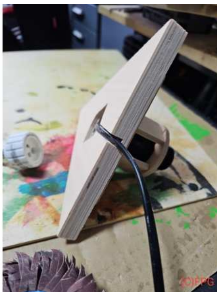
Bild: 4.24 Hier der Blick auf die Durchführung des Kabels
