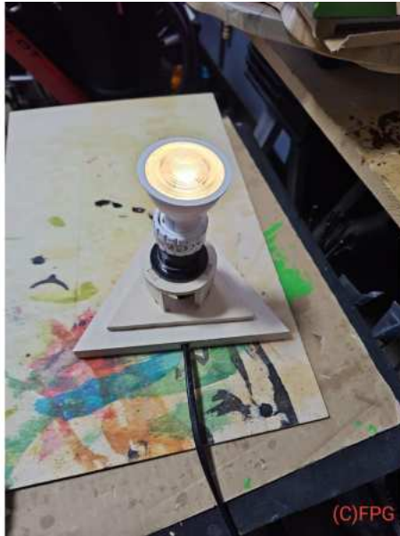
Bild: 4.22 Das Kabel läuft ohne Probleme unter dem Sockel durch. Gedimmte und...
