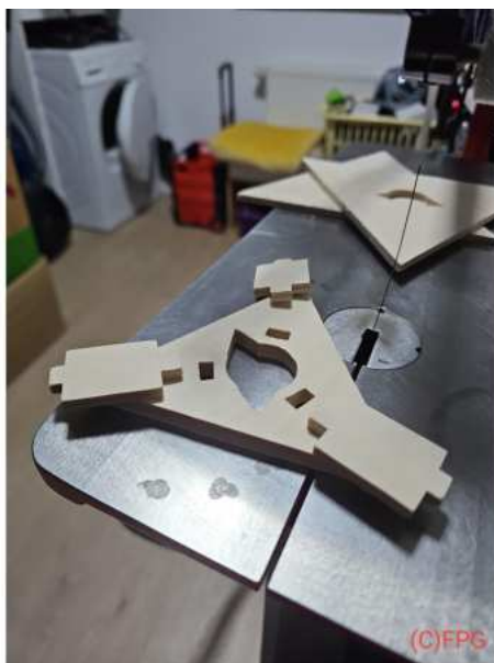
Bild: 4.3 Die untere Seite des Sockels mit den Abstandshaltern für die Lampenfassung
