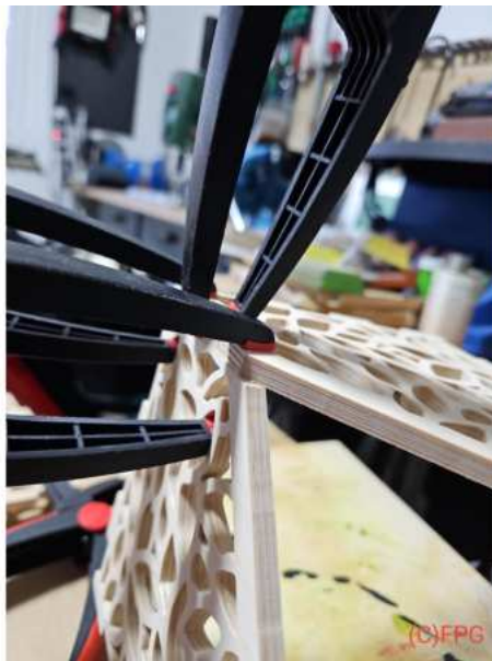
Bild: 4.17 Man kann da nur mit Spitzklemmen arbeiten
