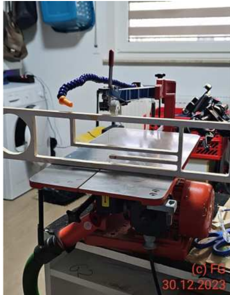
Bild: 2.7 Die fertig gesägte obere Platte mit den Ausschnitten zur Ablage meiner Sachen
