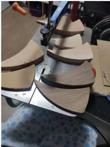
*Bild: 2.1 Die gesägten Teelichthalter der verschiedenen Hölzer sind bei beiden Holzplatten (20mm und 10mm) im Umriss gleich gesägt*
