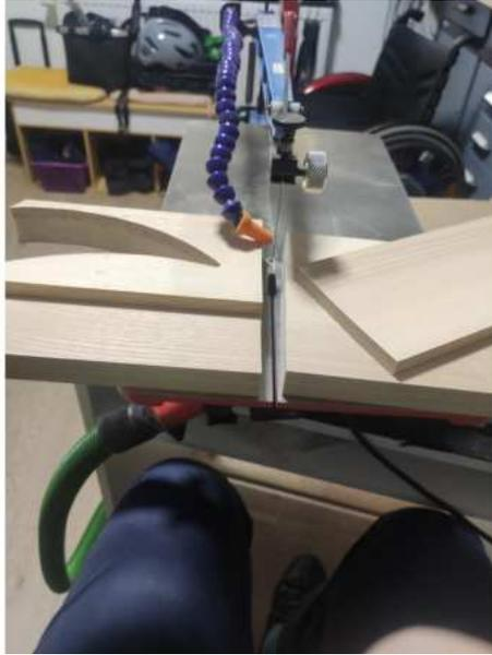
*Bild: 2.2 Jetzt nur noch die beiden Bretter am Ende des nicht verleimten Bereiches trennen und man erhält den Rest der Holzplatten zur weiteren Verwendung sauber zurück*
