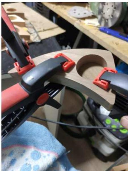
*Bild: 4.5 Mit Zwingen zusammendrücken und warten, bis der Leim getrocknet ist*
