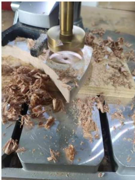
*Bild: 3.6 Langsam mit nicht zu starken Druck das Loch bohren*
