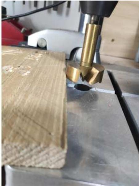
*Bild: 3.5 Den Forstnerbohrer so einstellen, dass die Bohrung komplett durch die 20mm Platte geht*
