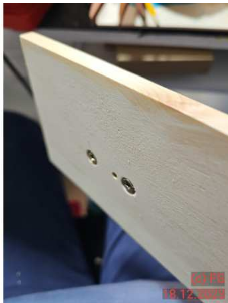
Bild: 3.7 endgültige Bodenplatte mit eingelassenen Schrauben
