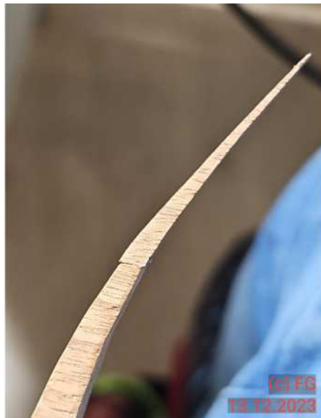
Bild: 1.3 Schaden am Ende eines Bogens. Lies sich aber noch leicht reparieren.
