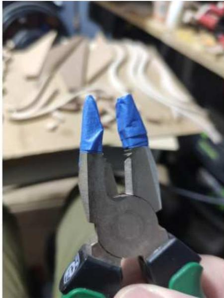
*Bild: 2.2 ... umwickelte die Zange mit dem Klebeband und...*
