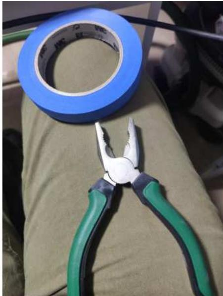
*Bild: 2.1 Um die kleinen Teile beim Schleifen besser halten zu können, nahm ich eine Flachzange und Klebeband...*
