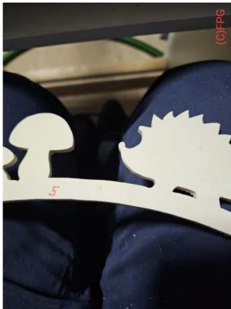
Bild: 3.3 Zusätzlich habe ich die gebogenen Böden nummeriert, um sie später auch in der richtigen Reihenfolge zu verleimen.
