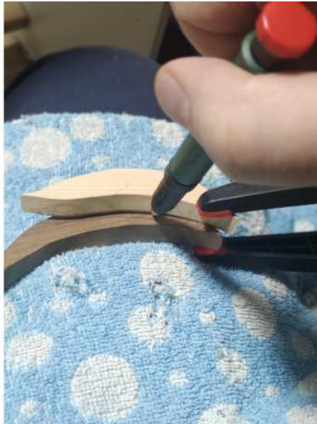
Bild: 3.1 Die Teile mit dem Stift anzeichnen um den Klebebereich festzulegen
