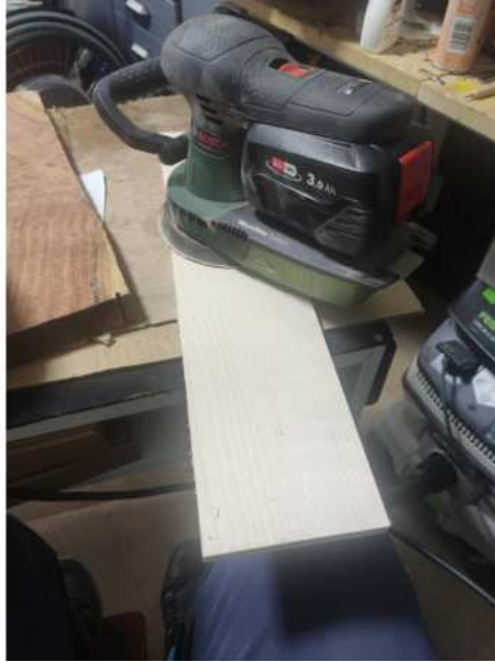
Bild: 1.1 Alle Holzplatten bis hin zu einer feinen Körnung von der Oberfläche bearbeiten
