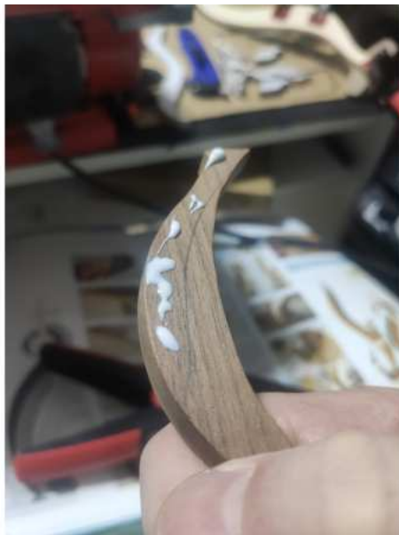
Bild: 3.1 Die Teile mit dem Stift anzeichnen um den Klebebereich festzulegen
