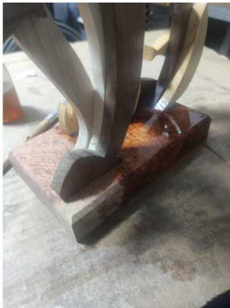
Bild: 4.2 Hier sieht man wieder den extremen Unterschied zwischen mit Öl behandelten und nicht behandelten Holz
