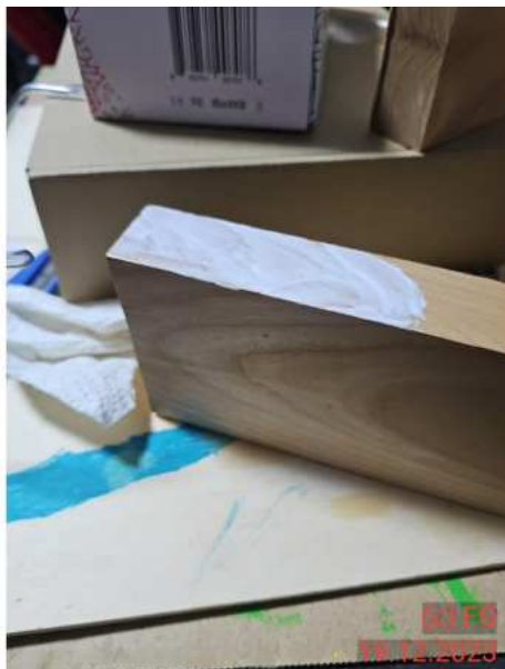
Bild: 1.1 Von dem Stück Restholz musste ich noch ein kleines Stück seitlich leimen.
