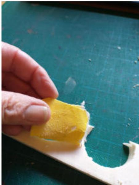
*Bild: 8.5 Etwas glatt schleifen*
