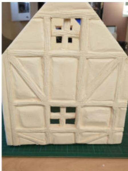
*Bild: 2.6 Fenster ausschneiden und den Innenschnitt fürs Fensterkreuz benutzen*
