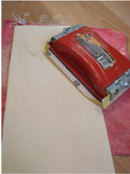
*Bild: 1.3 Außenseiten mit 60er Schmirgelpapier Strucktur der Platte abschmiegeln*
