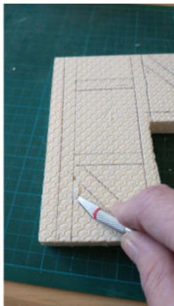
*Bild: 2.3 Schräg mit dem Cutter zur Schnittlinie langfahren*
